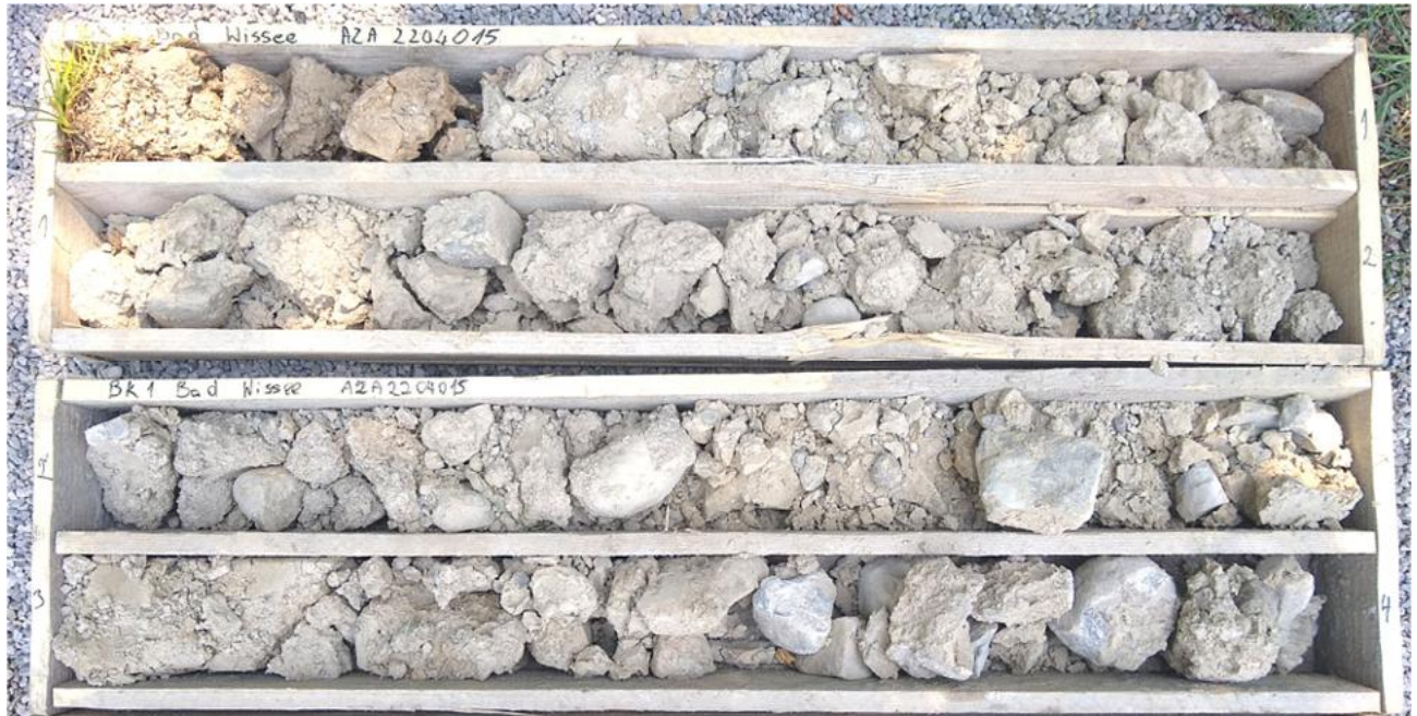
Abb. 1, 20.07.2022: Bohrprofil BK 1, Tiefenbereich 0,0 - 4,0 m u. GOK
