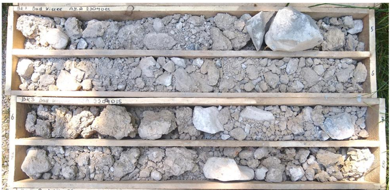
Abb. 6, 20.07.2022: Bohrprofil BK 3, Tiefenbereich 4,0 - 8,0 m u. GOK
