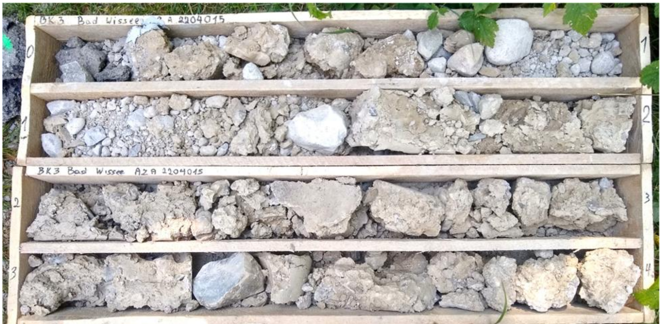
Abb. 5, 20.07.2022: Bohrprofil BK 3, Tiefenbereich 0,0 - 4,0 m u. GOK
