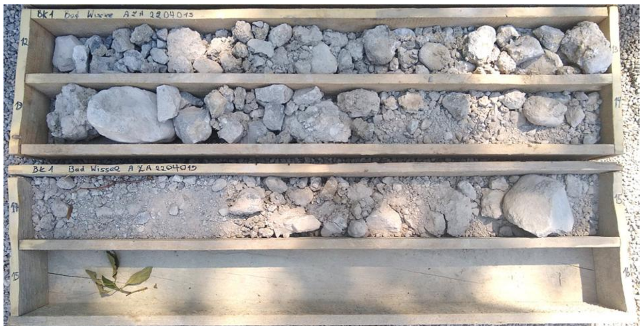
Abb. 4, 20.07.2022: Bohrprofil BK 1, Tiefenbereich 12,0 - 15,0 m u. GOK
